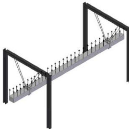
Figura 27: Viga colgada en estructura tipo caballete para representar la condición de borde "libre-libre".
