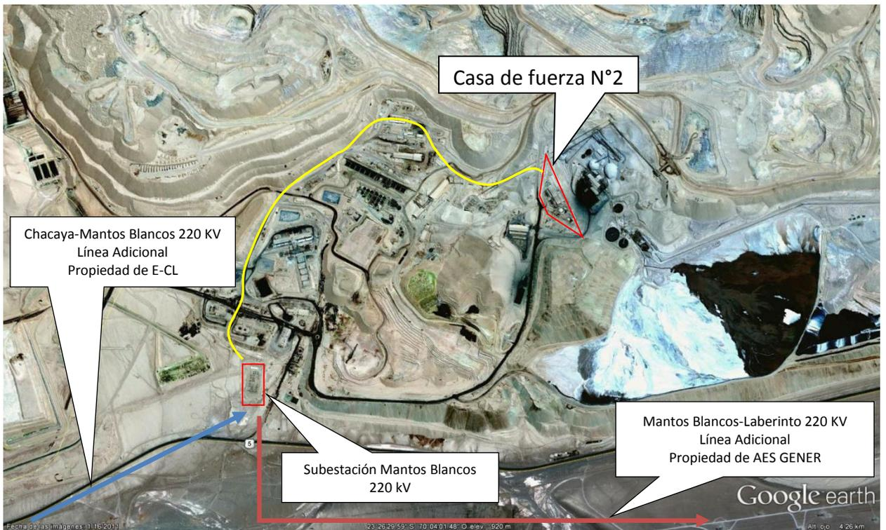
Ilustración 10: Líneas de transmisión adicionales que llegan a la central diesel.
