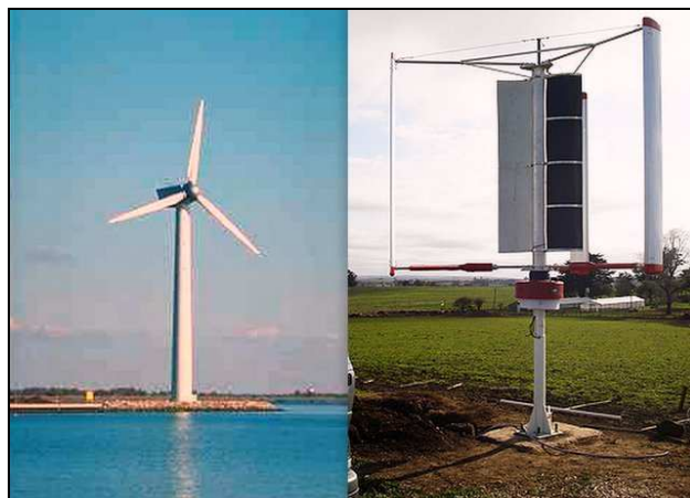
Figura 4. Aerogenerador de eje horizontal tri-pala (izquierda) y aerogenerador de eje vertical (derecha).
