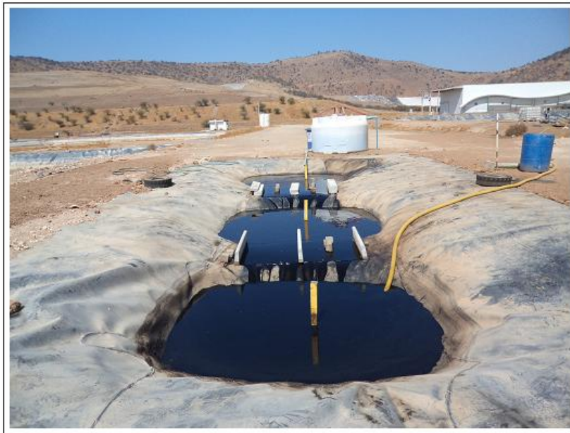
Figura 5.12 Sistema de rebalse entre bandejas de experimentación
