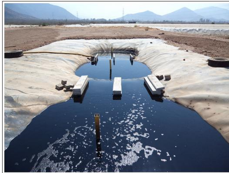
Figura 5.11 Sistema de rebalse entre bandejas de experimentación
