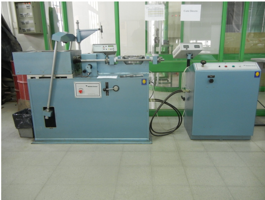
Figura 36: Equipo de corte directo para determinar propiedades de corte del material granular.
