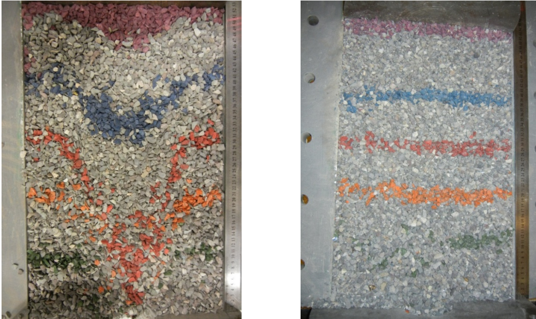
Figura 54: Geometría IMZ para un esfuerzo vertical = 0\text{ MPa} (izq.) y un esfuerzo vertical = 5.8\text{ MPa} (der.) para d_{50} = 6\text{ mm} .
