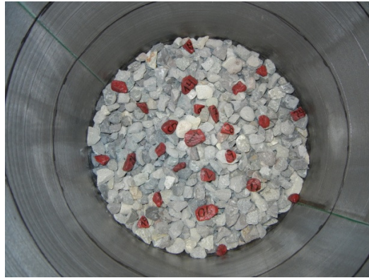
Figura 43: Marcadores pintados y rotulados numéricamente para medir las zonas de extracción (IEZ).
