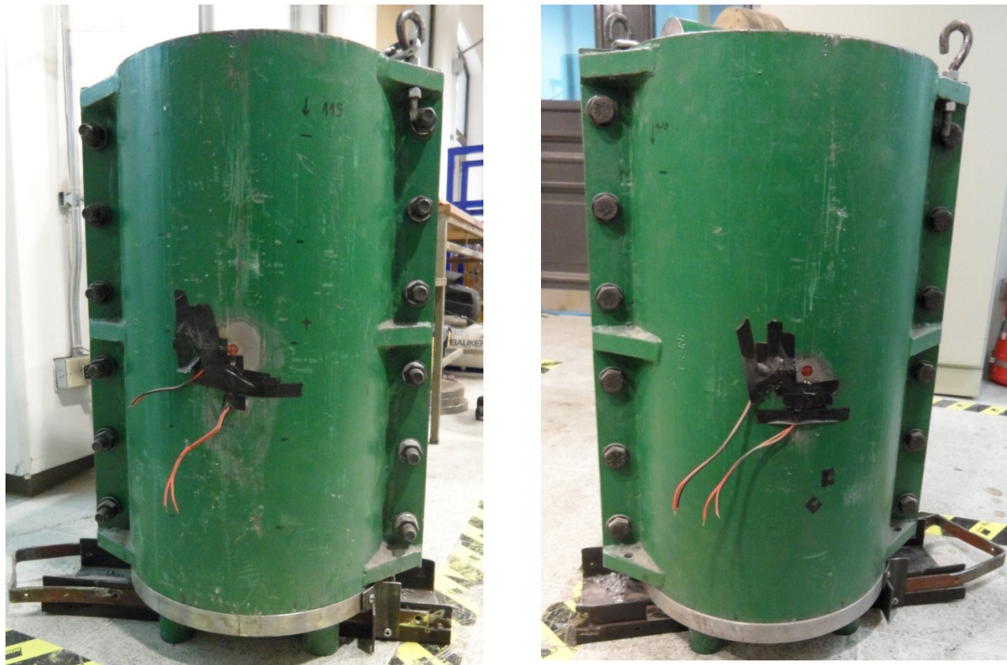
Figura 42: Aplicación de strain gauge en el cilindro de acero.
