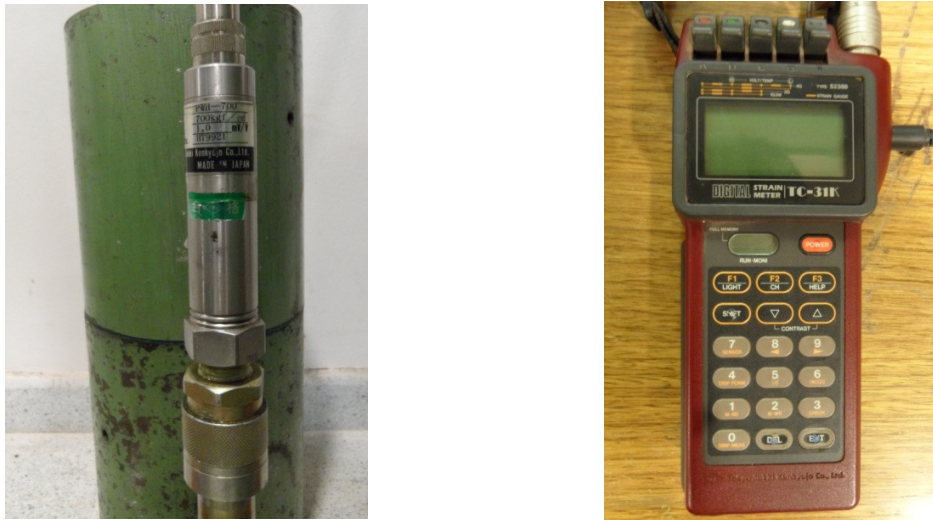
Figura 38: Transductor de presión y strainmeter para medir carga vertical que aplica la prensa hidráulica.
