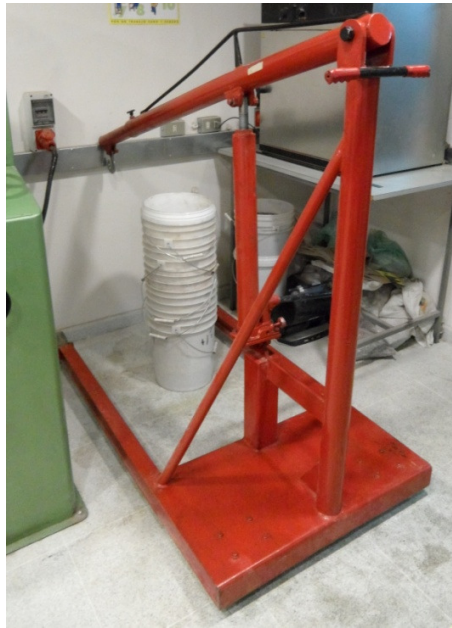
Figura 31: Tecla para colocar el cilindro de acero en la prensa hidráulica.
