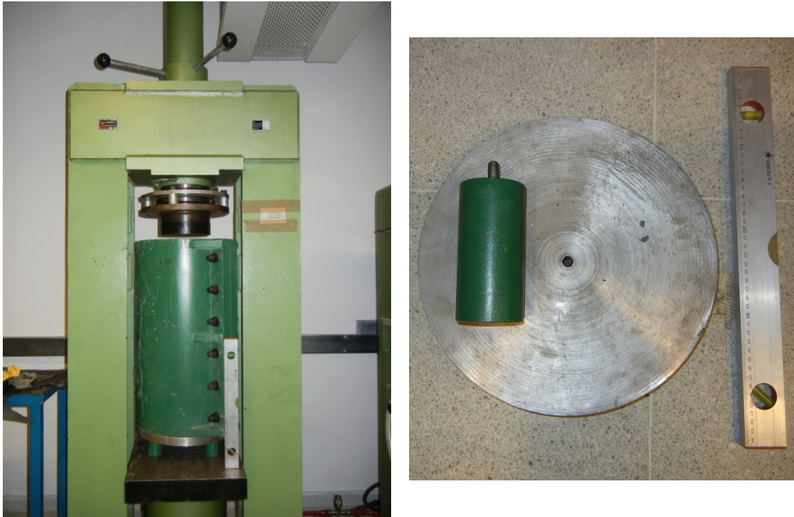
Figura 28: Prensa hidráulica y cilindro de acero (izq.) y pistón de acero (der.)
