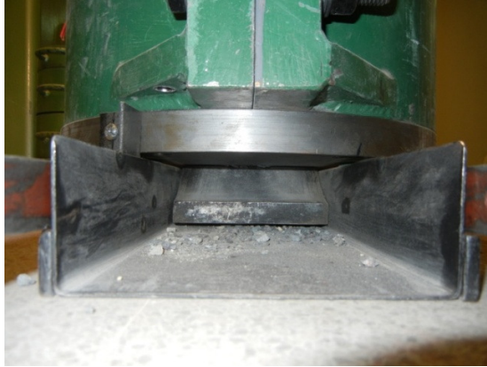
Figura 30: Sistema de extracción del cilindro de acero.
