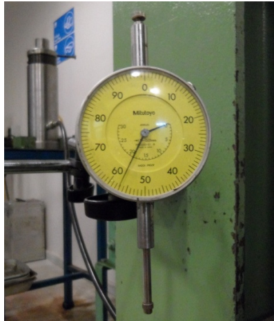
Figura 40: Dial de deformación para medir el desplazamiento del pistón.
