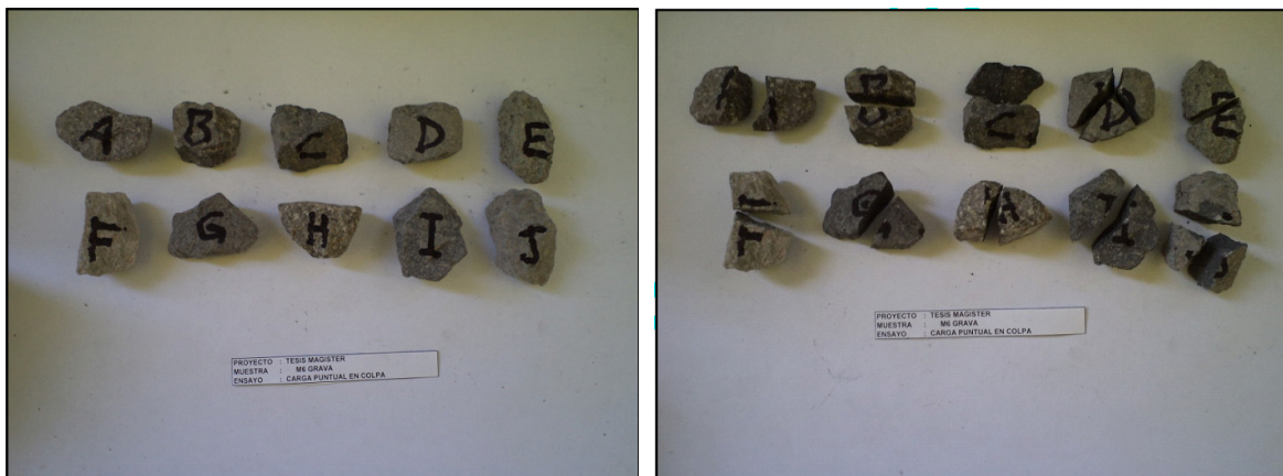
Figura 51: Ensayo de carga puntual antes y después del test donde las muestras fallan por matriz.
