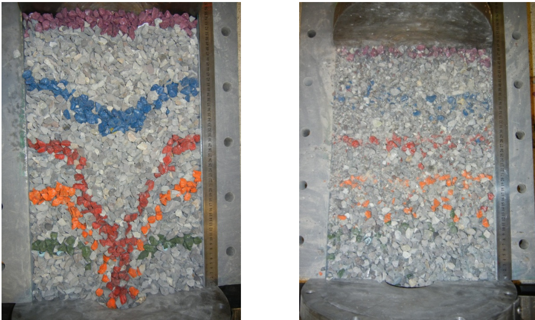
Figura 60: Geometría IMZ para un esfuerzo vertical = 0 MPa (izq.) y un esfuerzo vertical = 13.2 MPa (der.) para d_{50} = 11 mm.
