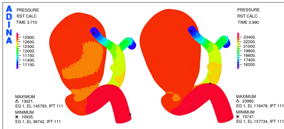
Figura 5.137: Simulación 10. Distribución de presión en la geometría completa para diástole (0,92 [s]) a la izquierda y para sístole (1,2 [s]) a la derecha.
