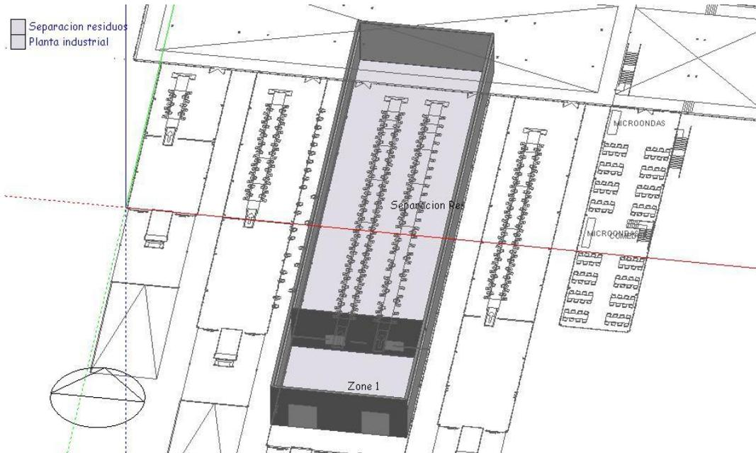
Ilustración 10-8 Volumen tipo escogido para realizar la simulación térmica en programa Design Builder
