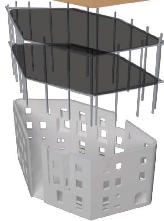
Pórtico interno de acero, con vigas de 30x20 mm
