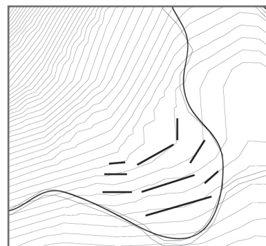
2. Los muros de contención se desarrollan paralelos a la cota del terreno.
