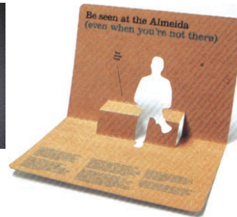
Troquel de plisado para los dobleces y de corte para el calado.
