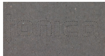
Troquel de prepicado. Comúnmente se utiliza para dejar una parte del sustrato desprendible, como en el caso de las boletas. En este caso se utiliza en vez de tinta.
