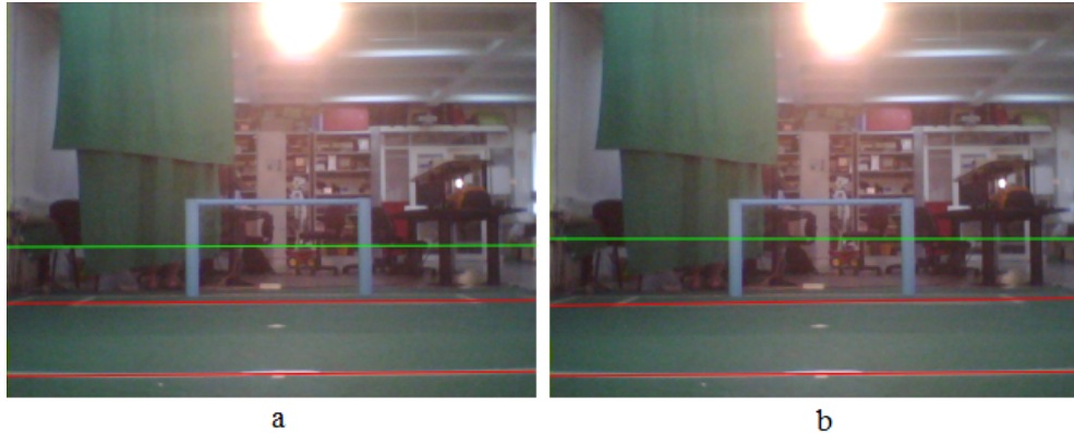
Figura 5.1: Situación 1. En ambas imágenes se pueden apreciar el horizonte visual, representado por una línea recta verde, y la detección de las líneas de la cancha representada por líneas rectas rojas. En la imagen a , el proceso de calibración del estado M de la cámara no se ha realizado y en la imagen b sí. La calibración se puede apreciar en el cambio de altura del horizonte visual. En la imagen b , el horizonte visual se encuentra más cercano a la altura de la cámara del robot.
