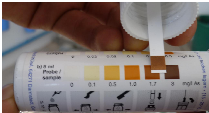
Figura 4-9 Test kit de medición de arsénico: se obtiene la concentración de la muestra en rangos estimados mediante una comparación visual con la escala colorimétrica.
