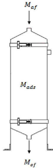
Figura 5-4 Diagrama explicativo del balance de masa en la columna (no a escala)
