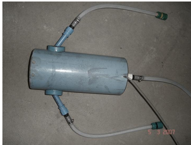
Fig. 3.4: Fotografía cámara de mezcla
