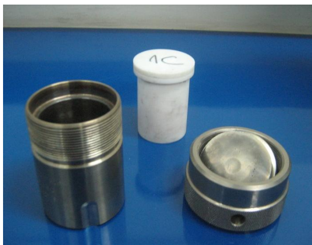
Figura 27: Componentes de un reactor Parr: vaso de teflón, camisa, y tapa de acero inoxidable.
