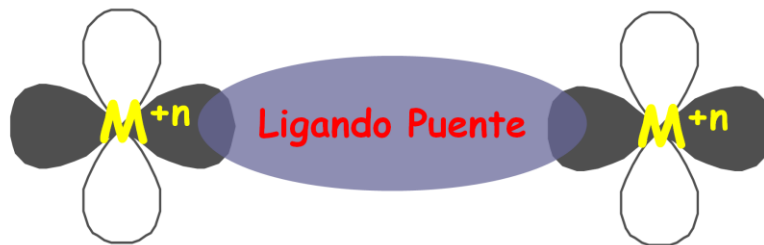
Figura 9: Esquema que representa la unión entre los centros metálicos paramagnéticos, por medio de un ligando puente, lo que hace posible el fenómeno de superintercambio magnético. [28] .
