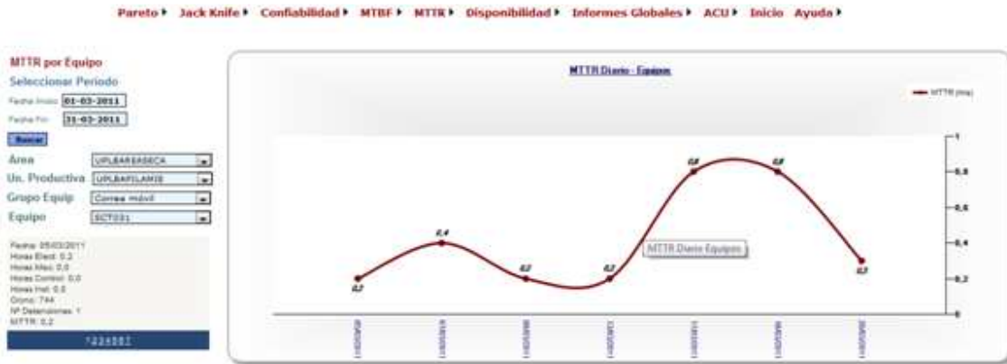
Ilustración 0-174: Tiempo medio entre reparaciones acumulado diario por equipos individuales
