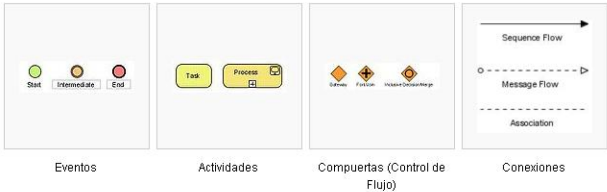
Figura 4. BPMN, objetos de flujo y conexión
