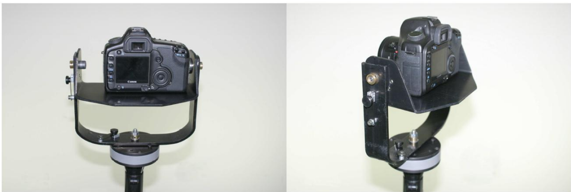
Figura A.10: Cámara con soporte angular vertical y horizontal.
