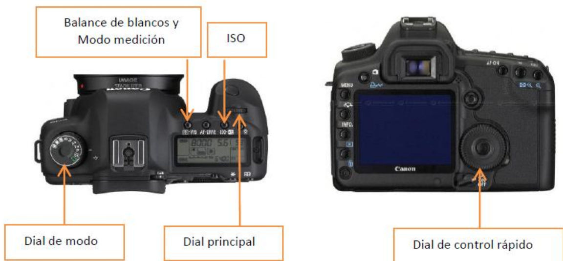
Figura A.2: Botones para configurar los parámetros de la cámara (Leiva 2012, SGL- FD-01).
