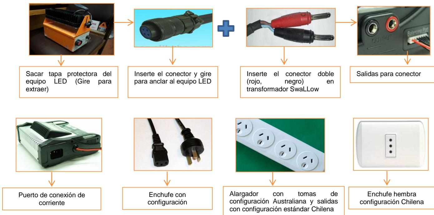
Figura A.8: Diagrama para la correcta carga de la batería de los paneles LED (Leiva B. 2012).
