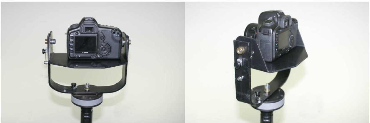
Figura 4.2: cámara fotográfica con marco con ángulos predeterminados para la toma de fotografías en frentes mineros en mina subterránea.
