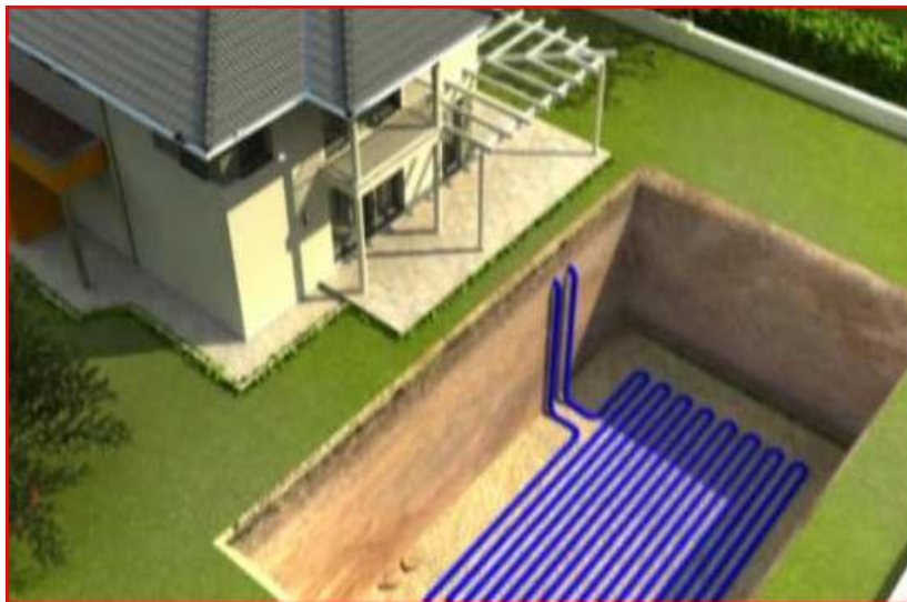
Figura 2.34: Piscina utilizada como reservorio térmico (de Miguel, 2008).
