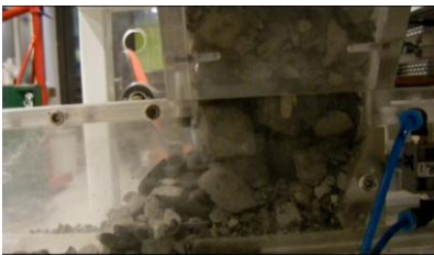
Figura 32: Sistema de descuelgue para colgaduras tipo 3
