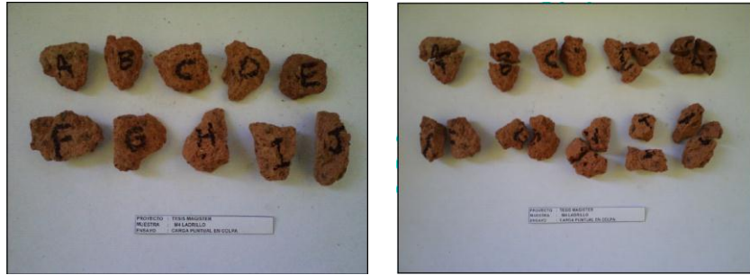
Figura 52: Fragmentos pre y post ensayo. Muestra Ladrillo
