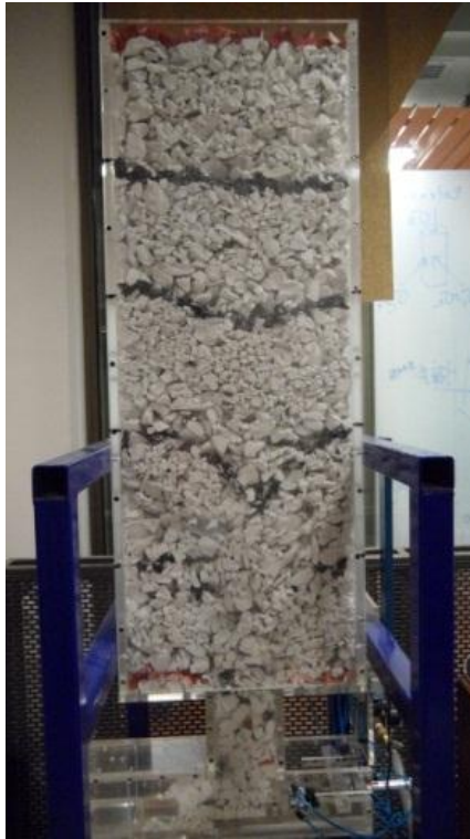
Figura 36: Disposición de marcadores modelo 2D. La fotografía corresponde al modelo luego del proceso de extracción. Se observa en consecuencia las líneas de flujo.
