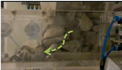
Figura 31: Sistema de descuelgue para colgaduras tipo 2
