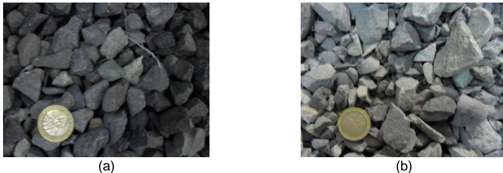
Figura 17: Granulometrías empleadas en evaluación Minería Continua modelo 3D Módulo Andina. a) Monotamaño d_{50}=18 [mm] (0.9 [m] escalado) b) Granulometría Andina Primario
