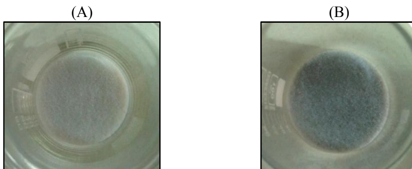
Figura 4-1 (A) Catalizador Ni/Al 2 O 3 λ100 sin reacción, (B) catalizador Ni/Al 2 O 3 λ100 luego de ser utilizado en la reacción de metanación a 270°C.
