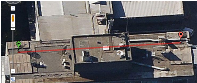
Figura 4.23: Medición online de la distancia entre las bases de las antenas. Distancia total 37.8543 m.
