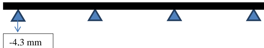
Figura 5-10: Desplazamiento de apoyos TS13 Eje Y, Noviembre (antes 13/11).
