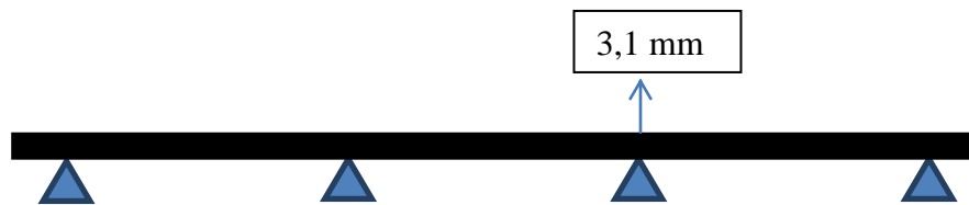
Figura 5-6: Desplazamiento de apoyos TS12 Eje Y, Diciembre.
