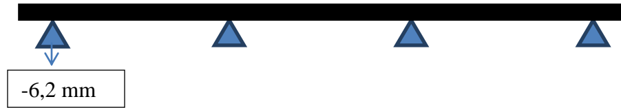
Figura 5-9: Desplazamiento de apoyos TS13 Eje Z, Noviembre (antes 13/11).
