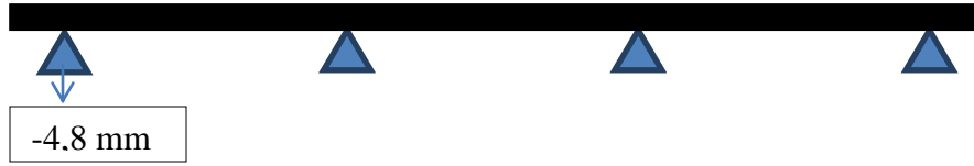
Figura 5-7: Desplazamiento de apoyos TS13 Eje Z, Octubre.
