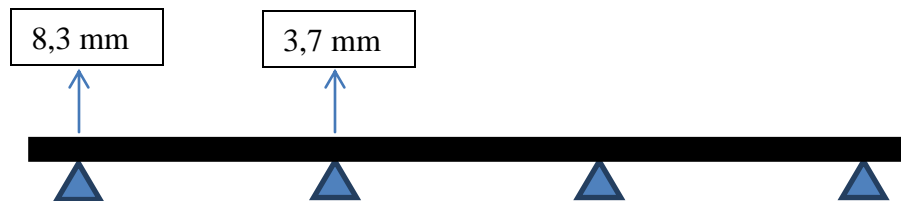
Figura 5-3: Desplazamiento de apoyos TS12 Eje Z, Noviembre.
