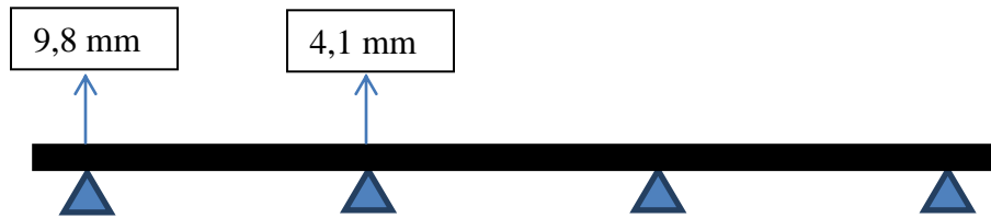
Figura 5-1: Desplazamiento de apoyos TS12 Eje Z, Octubre.
