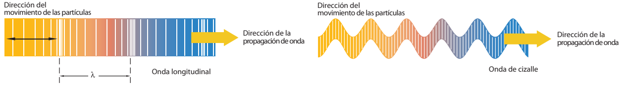
Figura 1.6: Ejemplificación de una onda acústica longitudinal y transversal que se propagan en una misma dirección. Imagen adaptada de [17]
