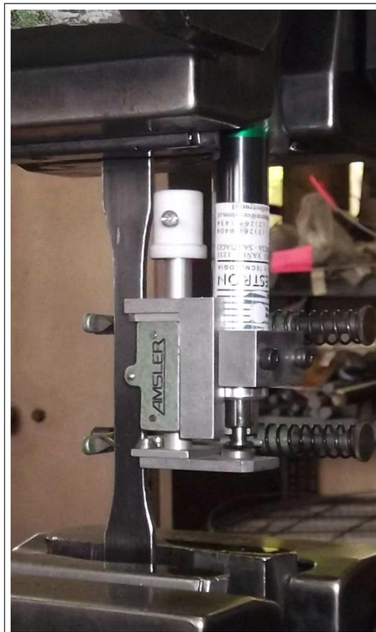
Figura 5.3: LVDT y probeta plana
