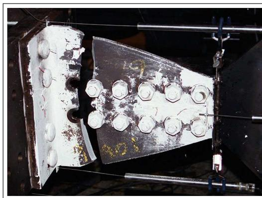
(b) Fractura del área neta - Probeta TA-01
