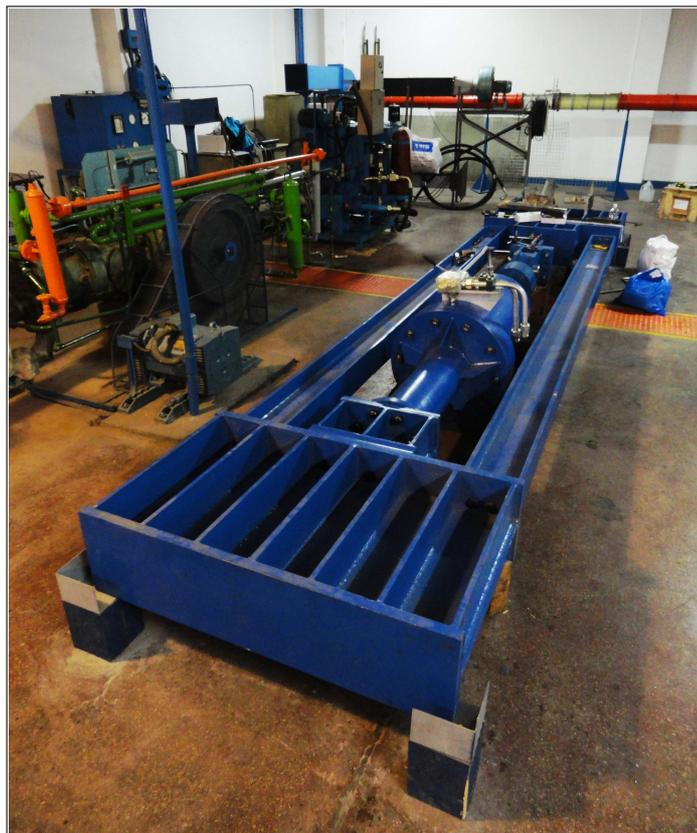
Figura 4.11: Fotografía del marco de reacción durante su instalación
