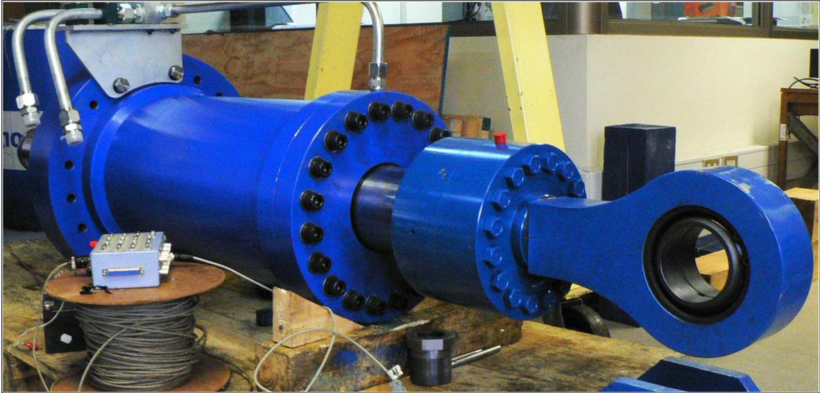
**Figura 4.12:** Fotografía del actuador y celda de carga durante pruebas de calibración
