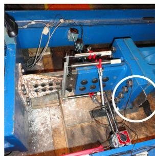
**Figura 7.6:** Desangulación corregida por placa delgada
