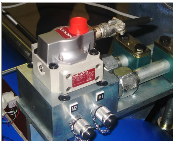
Figura 4.13: Fotografía de la servo válvula durante su instalación
