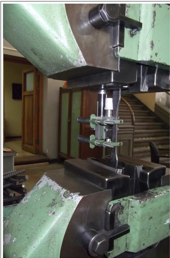
Figura 5.2: Máquina universal de carga - MFL
