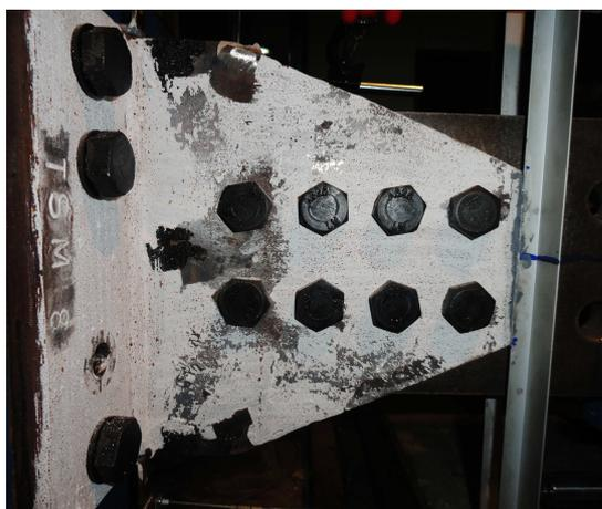
Figura 7.9: Fluencia tipo antes de la fractura
