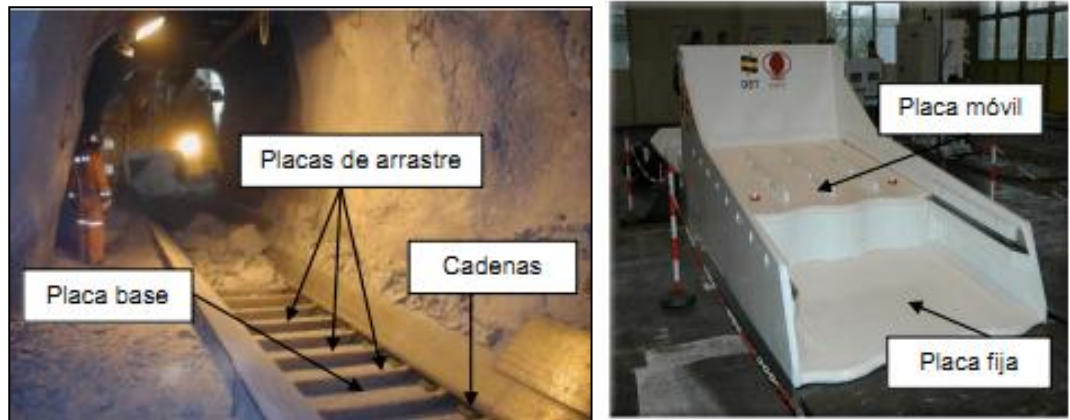
Figura 6: Equipo de transporte Panzer (izquierda) y equipos de extracción Dozer Feeder (derecha) (Encina y otros (2008))
