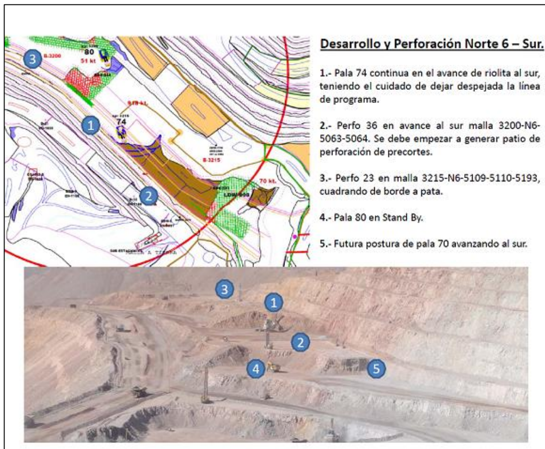
Imagen 20: Plan diario de perforación y tronadura con fotos reales
