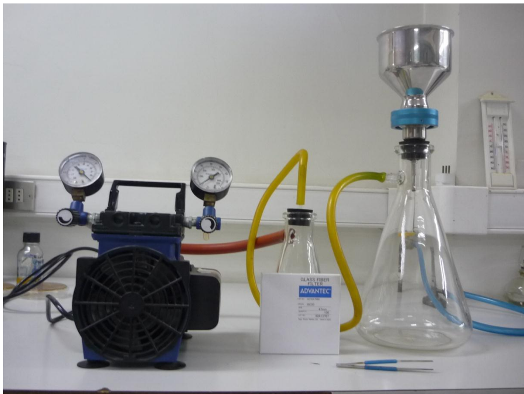
Figura 4.11 Filtros Boro-Silicato y Sistema de Filtrado.
