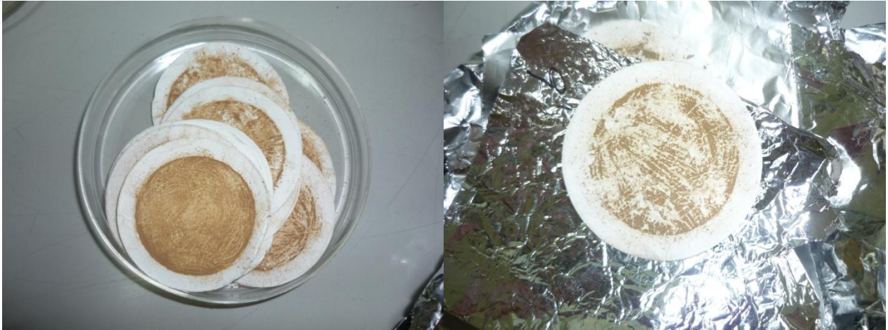
Figura 4.13 Estado de los filtros luego de realizar la extracción de los sedimentos.
