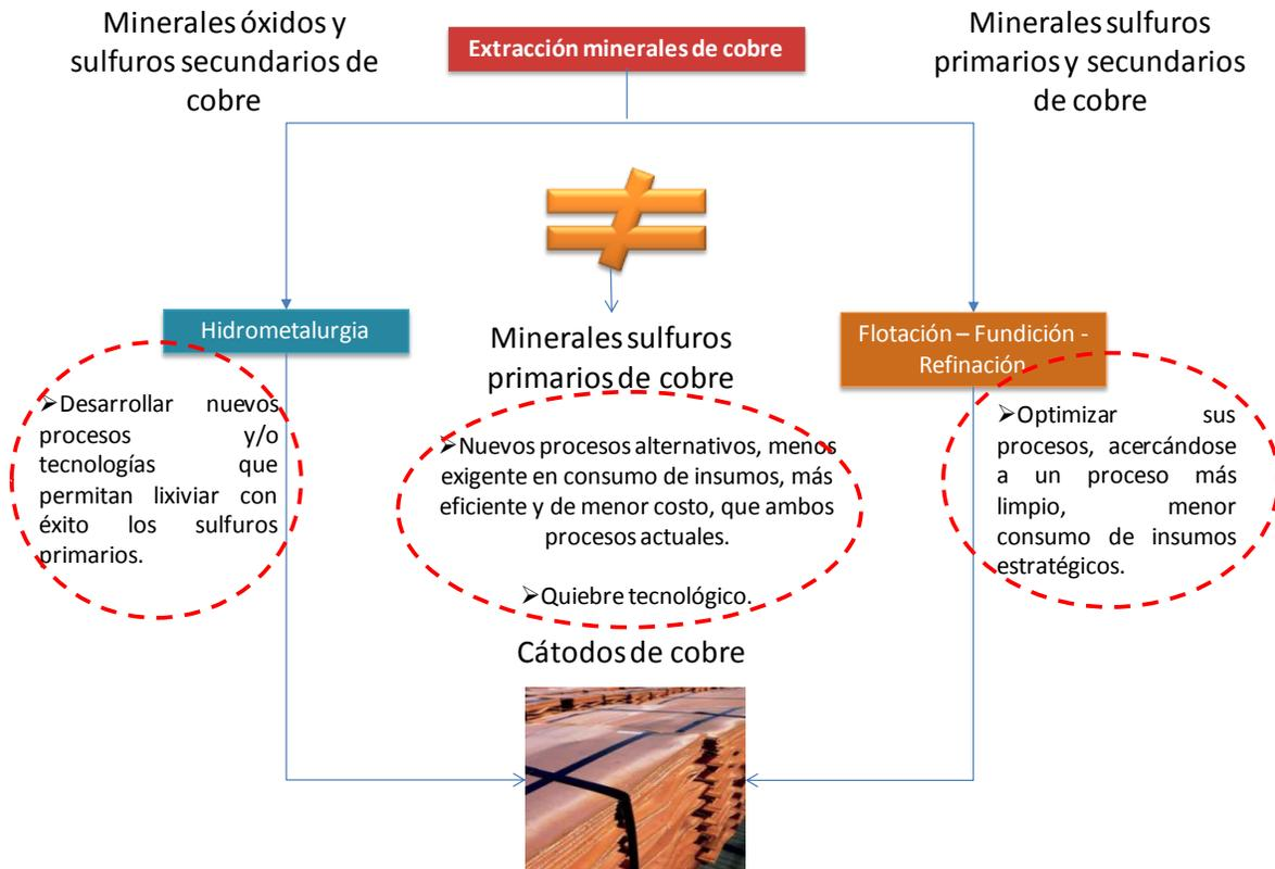
**Figura 9.4:** Estrategia basal propuesta para la formación de un “Copper Valley” en la diferenciación de procesos para producir cátodos de cobre.
