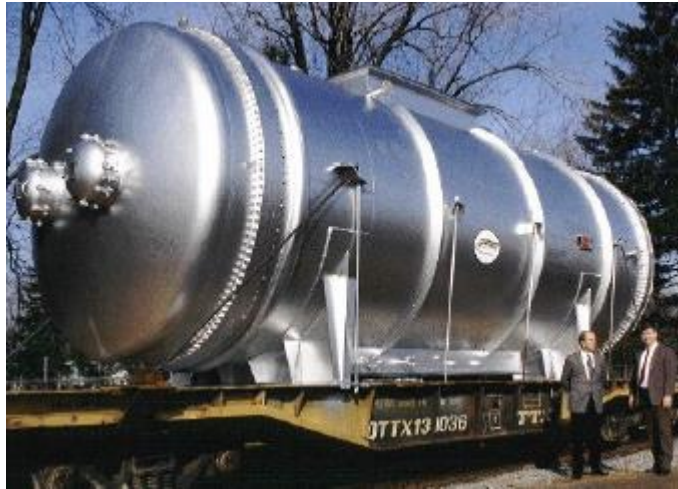
Figura 2.10 Condensador de carcaza y tubos.
