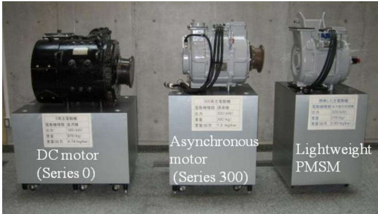
Figura 2.23: Comparación de tres motores de distintos Shinkansen .
