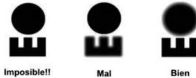
Figura 61, Correcta forma de visualizar el blanco (circulo), respecto al alza y la mira, donde se le pide al usuario enfocar la vista en las miras del fusil y dejando el blanco borroso, esta es una de las técnicas importantes de retener por el usuario.
