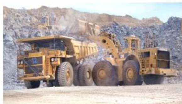
Figura 2: Flota Camión 830-AC con Pala PC-5500 (izquierda) y Camión 830-E con Cargador 994 D (derecha)
