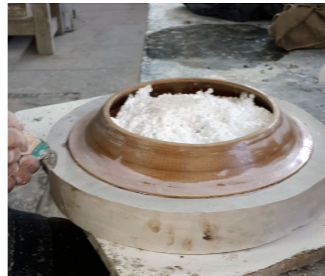
Fabricación del molde de yeso del anillo
