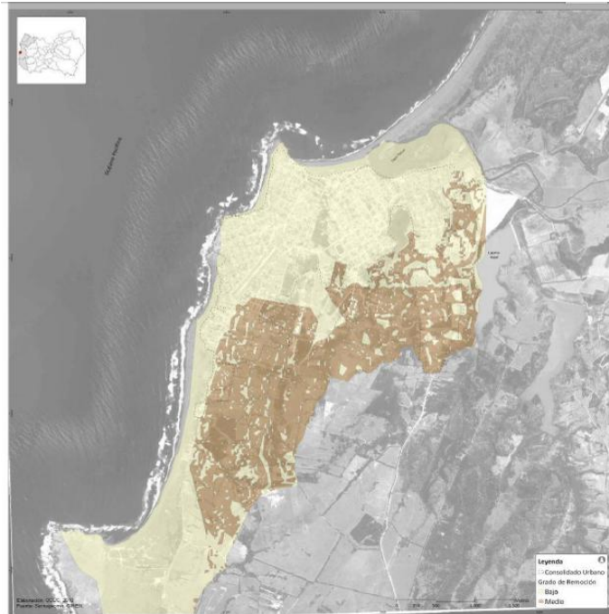
Figura N°9: Remoción en masa producida por sismo
