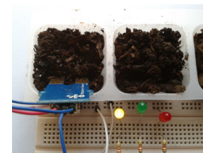
sustrato exceso humedad
