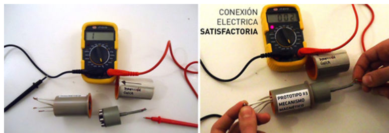
Imagen 68. Comprobando la conexión eléctrica en el conector de datos imantado. Fuente: elaboración propia.
