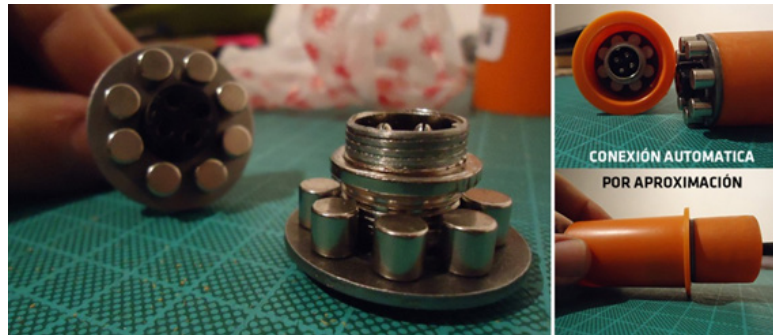
Imagen 66. Exploraciones en la conexión imantada. Fuente: elaboración propia.
