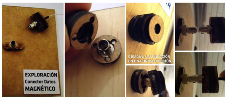
Imagen 65. Primeras pruebas con imanes en el conector. Fuente: elaboración propia.
