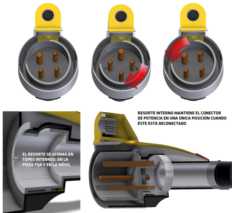
Imagen 96. Funcionamiento del resorte Fuente: elaboración propia.
