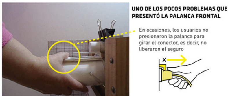
Imagen 76. No liberar seguro con el conector de palanca frontal. Fuente: elaboración propia.
