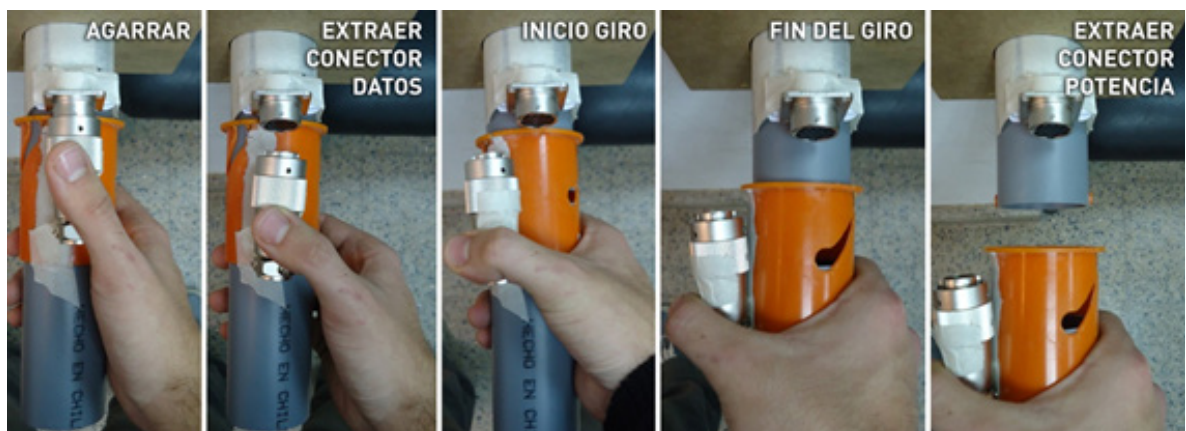
Imagen 69. Secuencia esperada para integrar los conectores. Fuente: elaboración propia.
