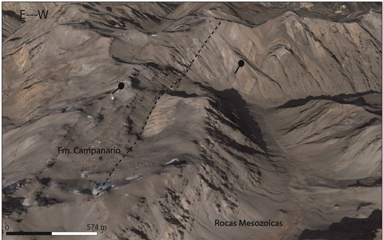
Figura III.22. Formación Campanario manteniendo levemente al Este, dispuesta discordantemente sobre rocas Mesozoicas de la Formación Río Damas y Baños del Flaco. Se observa la unidad deformada en su franja occidental.
