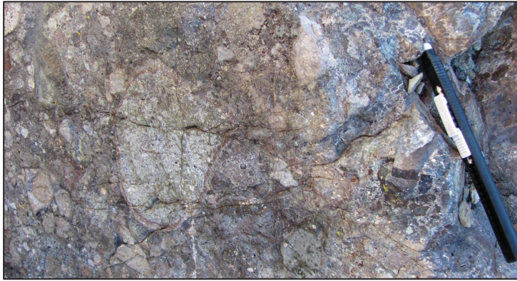
Figura III.14. Brecha polimítica con clastos volcánicos fuertemente alterada. Unidad (U3) Formación Abanico, descripción detallada en el texto.
