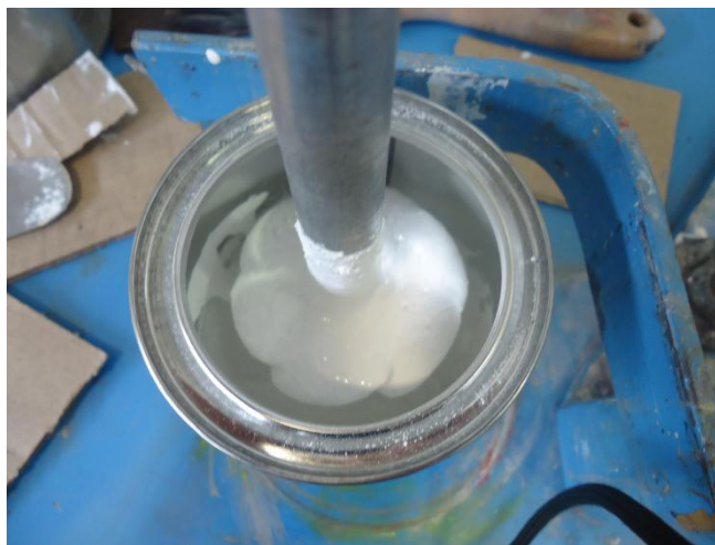
Figura 22. Inviabilidad del mezclado al preparar pinturas al 20% en peso.
