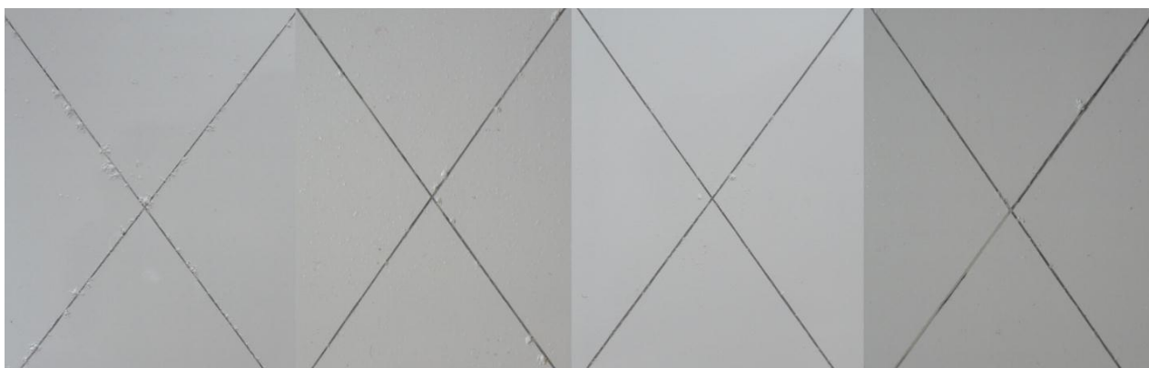
Figura 34. Placas después del ensayo de corrosión salina. De izquierda a derecha: Pintura base sin catalizador, Cristal, Sachtleben y Evonik. Catalizador al 3% en peso.
