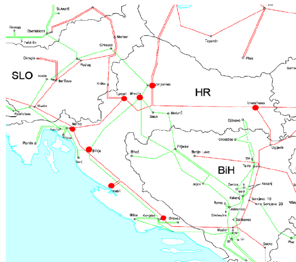
Figura 3.9: Localización de PMU en el sistema de transmisión croata (HR).
