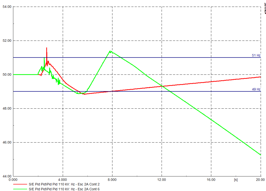
Figura 5.16: Frecuencia barra Pid Pid 110 kV para el caso en que el tiempo de retraso para la activación del esquema es de 120 ms . Contingencia 2 y 6, escenario 2A.
