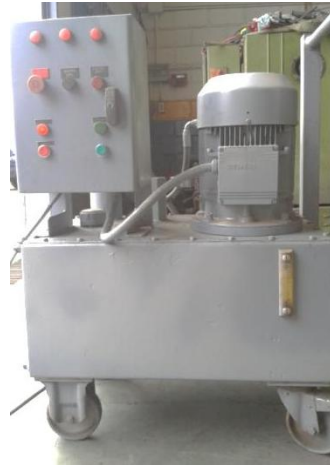
Figura 5.1: Unidad Hidráulica móvil empleada en las prueba de calibración y aprendizaje del transmisor de presión.
