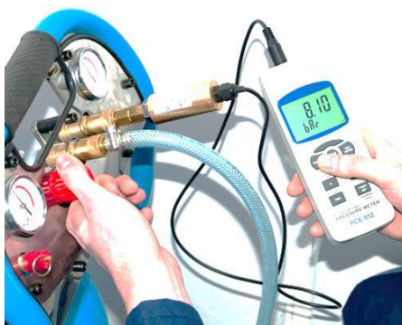
Figura A.4: Manómetro de presión con sensor externo
