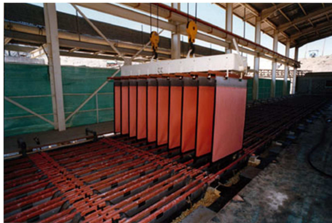
Figura 6: Piscinas de electro-obtención y cátodos recién extraídos
