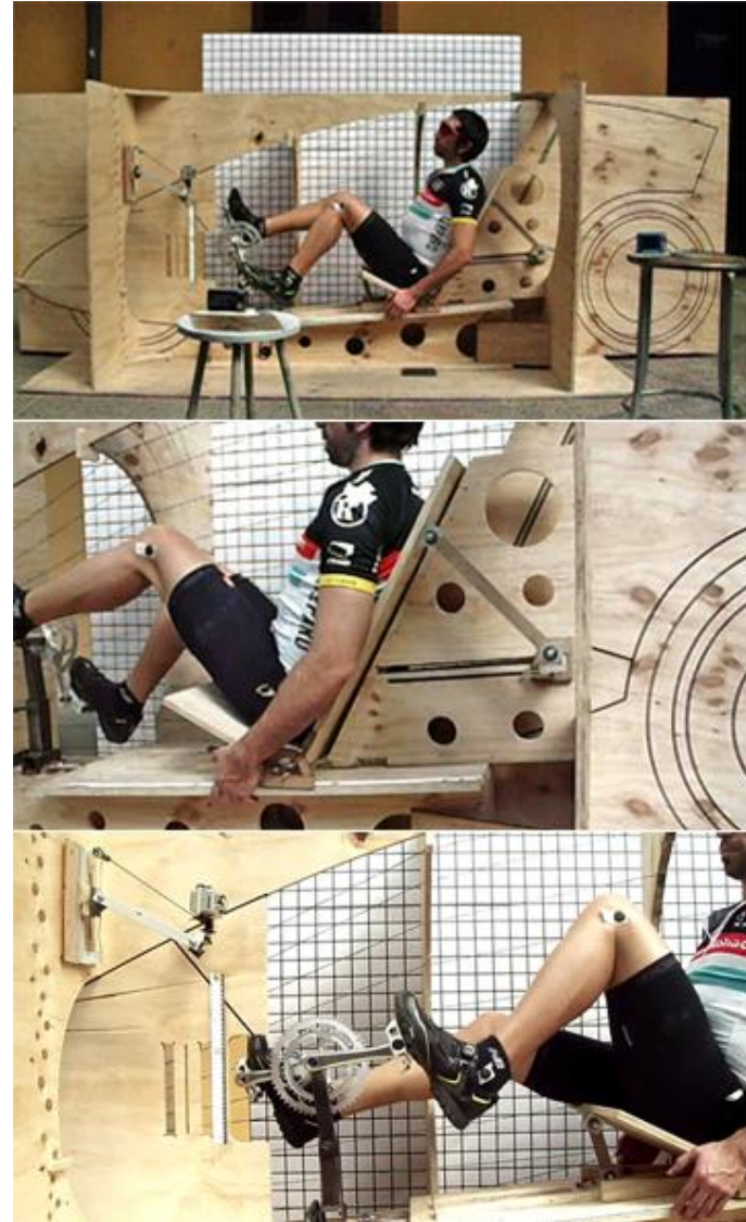
Imágenes: Pruebas con piloto en JIG 1. Elaboración propia.
