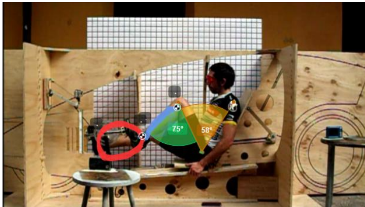
Imagen: Análisis recorrido y flexión máxima de piernas en prueba 3. Elaboración propia.
