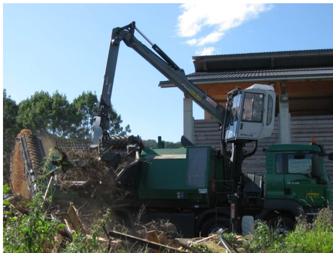
Astillador Komptech montado sobre camión, alimentado por una grúa
