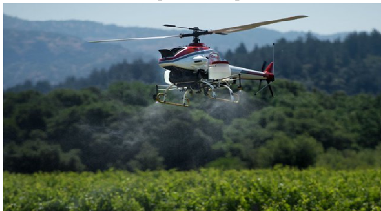
Ilustración 2-1 UAV utilizado en los viñedos del valle Napa de California para rociar pesticidas
