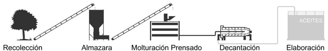
Figura 3. Esquema de las etapas para la elaboración del aceite de oliva.
