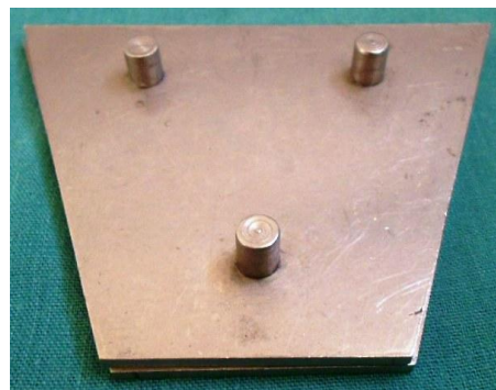
Figuras 3 y 4: formador de probetas utilizado para realizar las muestras.
