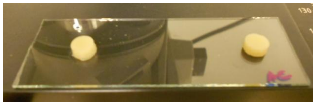
Figura 10: Muestras situadas sobre portaobjetos para ser sometidas a la prueba de microdureza.
