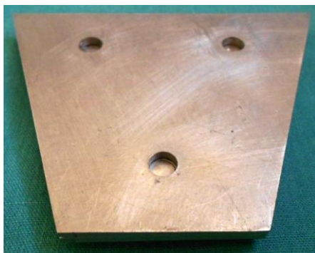
Figuras 3 y 4: formador de probetas utilizado para realizar las muestras.
