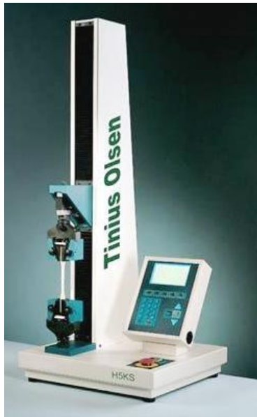
Figura 7: Máquina de ensayos universales Tinius Olsen H5K-s.
