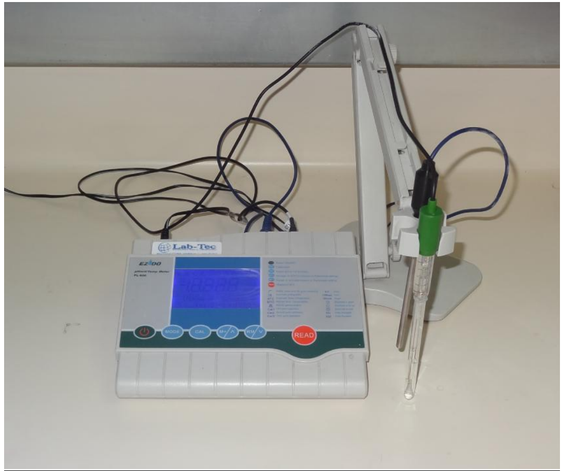
Imagen n° 3: pHmetro EZDO® PL-600 y microelectrodo.
