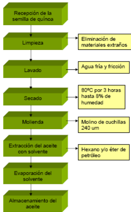
Figura 62. Diagrama de bloques del proceso de extracción de aceite de quínoa.
