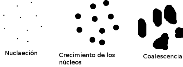
Figura 2.1: Esquema de nucleación, crecimiento y coalescencia.
