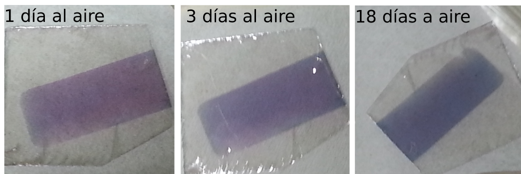
Figura 4.16: Imágenes de 1.5 nm fabricada a 791 K, donde no se puede apreciar un cambio visual.
