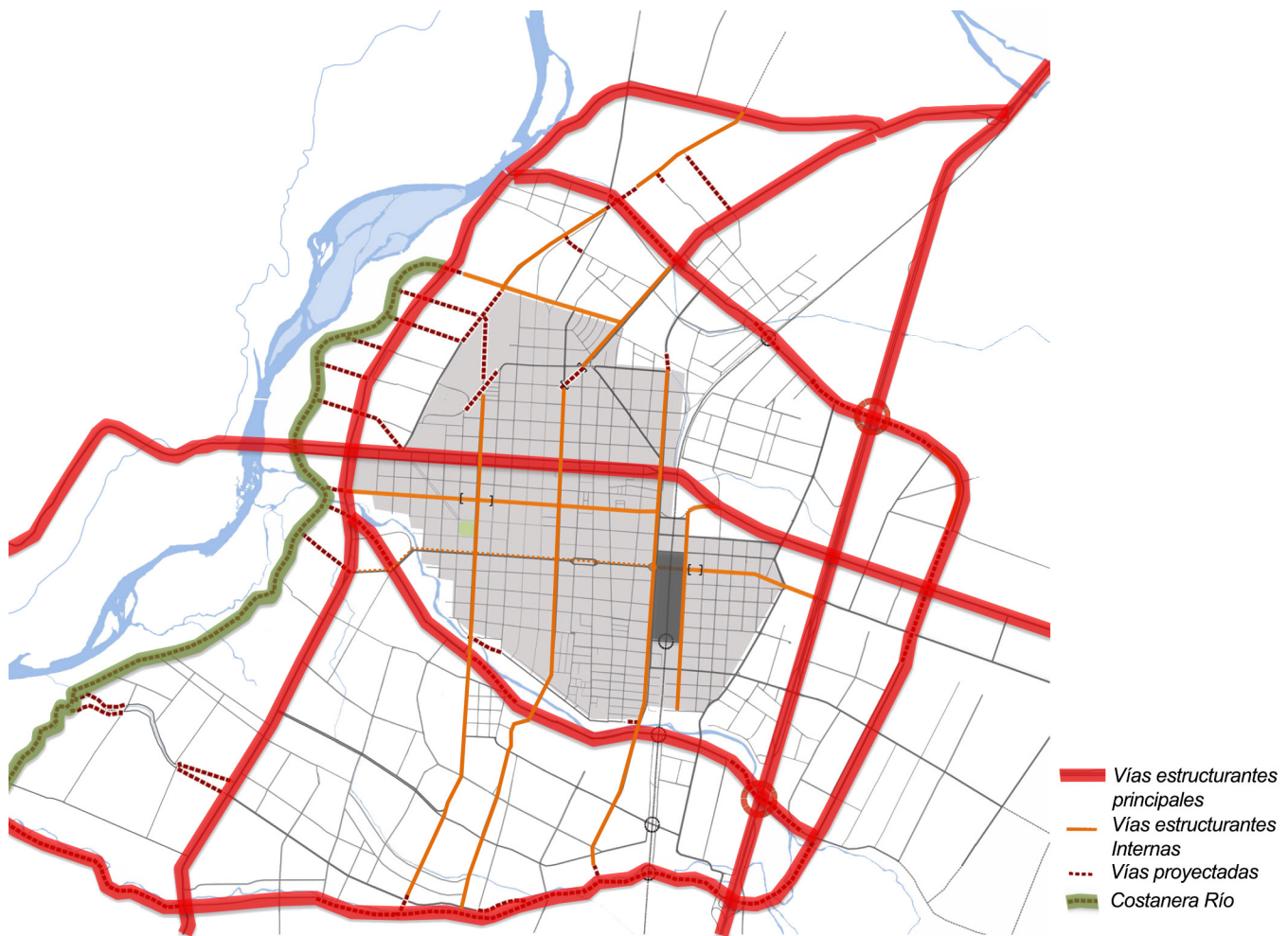
Ilustración 12 Estructuraciones propuestas, PRE Talca más intervención propia
